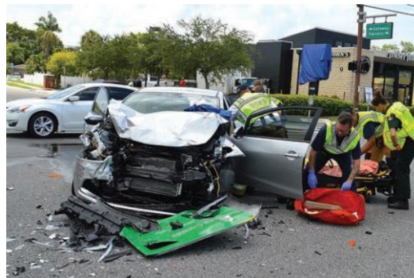
شکل 5-32. تصادف از جلو و شکستن شیشه جلو اتومبیل نشان‌دهنده این است که احتمالاً راننده به جلو پرت شده و سرش با شیشه برخورد کرده است.
