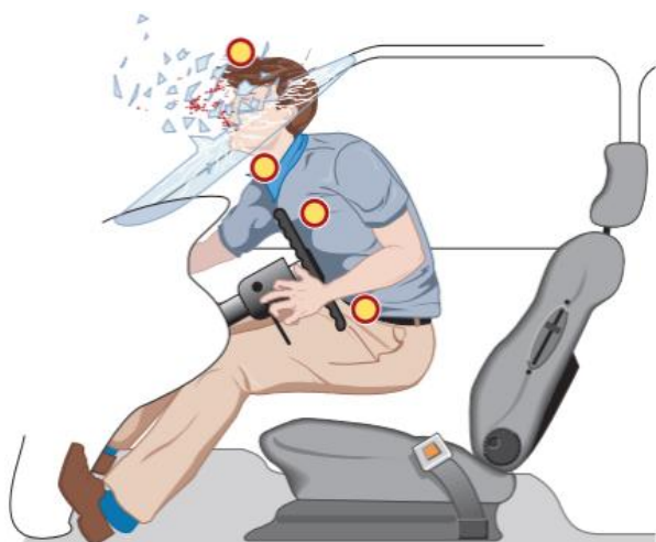
شکل 6a-27 راننده شدن به بالا و روی فرمان باعث ضربه به سر، گردن، قفسه سینه و شکم می‌شود.
