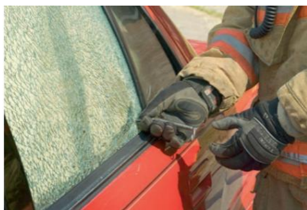
■ 43-1 B با ننگ داشتن نوک فنر در محل خود، فنر را رها کنید تا پنجره را خرد کند.
