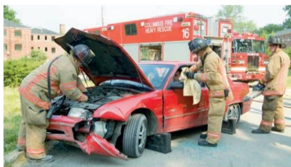
■ 42-3C بیمار باید با پتوی ضد آتش پوشانده شود. هوا باید از لاستیک‌ها خارج شود و باتری جدا شود. همیشه ابتدا ترمینال منفی را جدا کنید.
