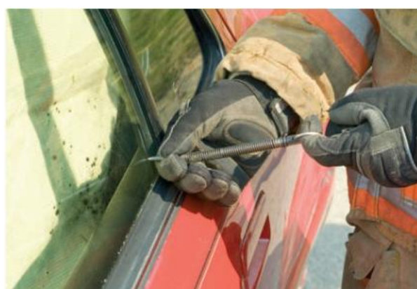
■ 43-1 A سر فنر را در گوشه‌ی پنجره‌ی کناری وارد کنید و فنر را به عقب بکشید.
