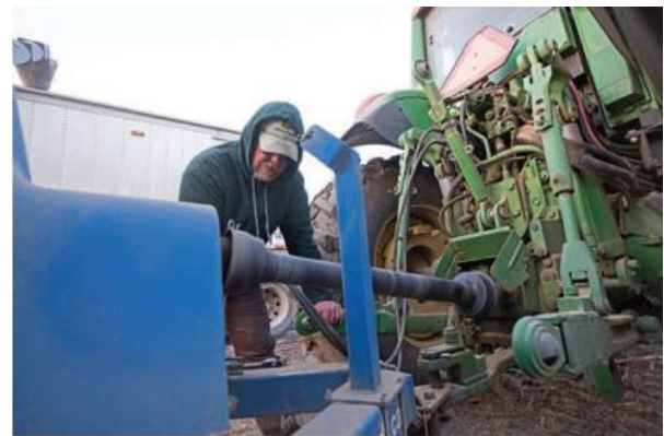
تصویر 3-3A محور انتقال قدرت بین یک تراکتور و یک وکیوم غلات است که به مکش غلات به درون یک مخزن می‌پردازد.
