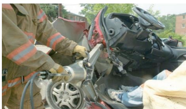
■ 43-3 J از دستگاه‌های پخش کننده هیدرولیک برای رهایی بیمار از گرفتار شدن توسط داشبورد استفاده می‌شود.
