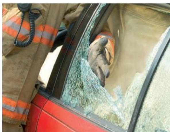
■ 43-1 C از بالای پنجره شروع کنید و، شیشه‌های شکسته را با احتیاط به دور از قسمت داخلی خودرو جدا کنید.
