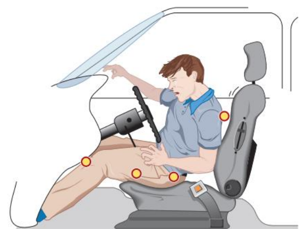
شکل 6b-27 راننده شدن به پایین و زیر فرمان باعث ضربه به زانوها، رانها، مفاصل هیپ، استابولوم و ستون فقرات می‌شود.
