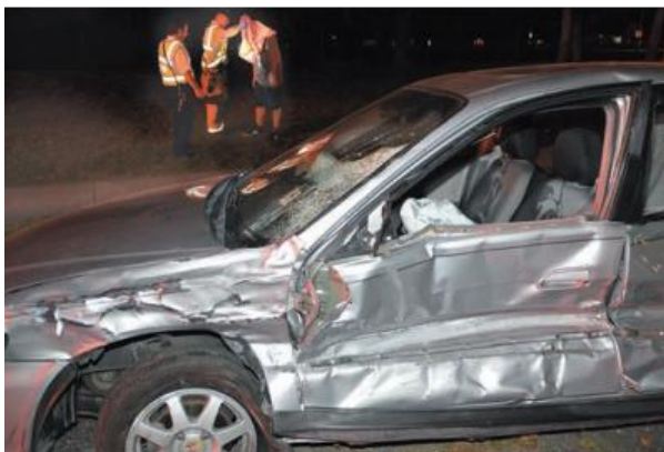
شکل 10-27 ترک خوردگی شیشه جلو در اثر باز شدن ایربگ.
