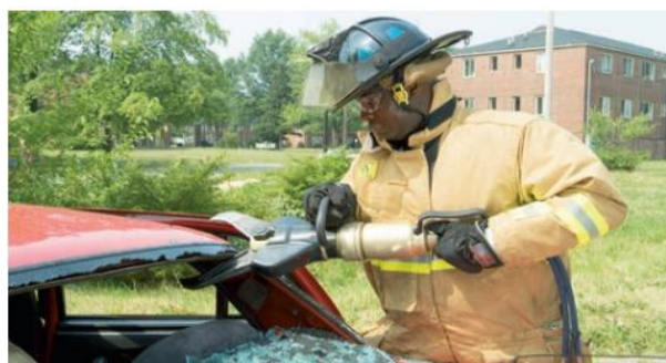
■ 43-3 H قیچی‌های هیدرولیک برای برش سقف وسیله‌ی نقلیه استفاده می‌شوند.
