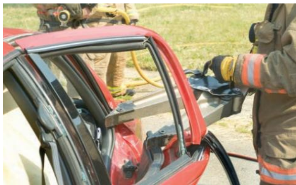
■ 43-3 D از پخش کننده‌های هیدرولیک برای "باز کردن" درب عقب استفاده می‌شود.
