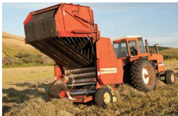
تصویر 4-3A یک غلتک. ممکن است که کارگر بلند شده و درون قسمت سرهم کردن علوفه کشیده شود.
