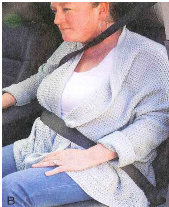
شکل ۲۰- ۱۰: نحوه بستن ناصحیح کمربند ایمنی. Source : PHTLS 2015
